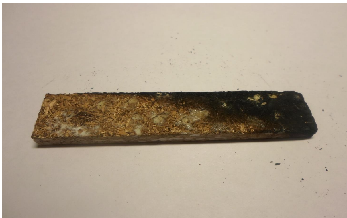
Рис. 3. Образец композита с добавкой калия фосфорнокислого однозамещенного после испытания в огневой трубе
