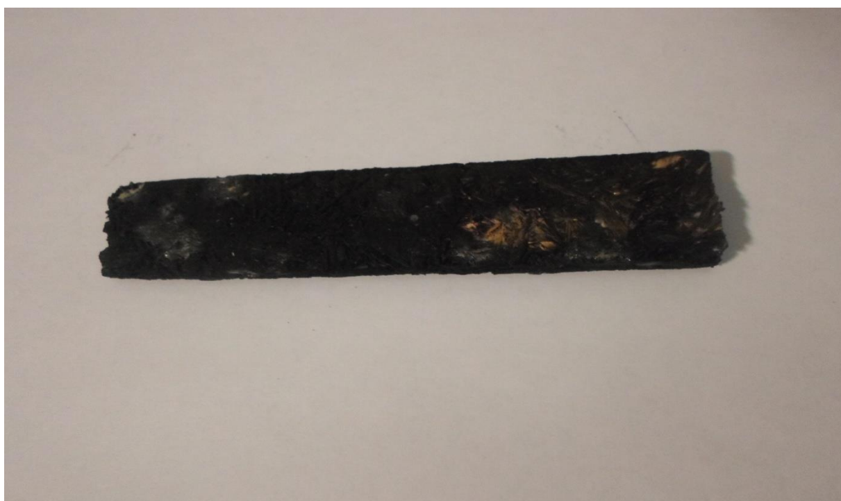
Рис.1. Образец композита с добавкой серы после испытания в огневой трубе
