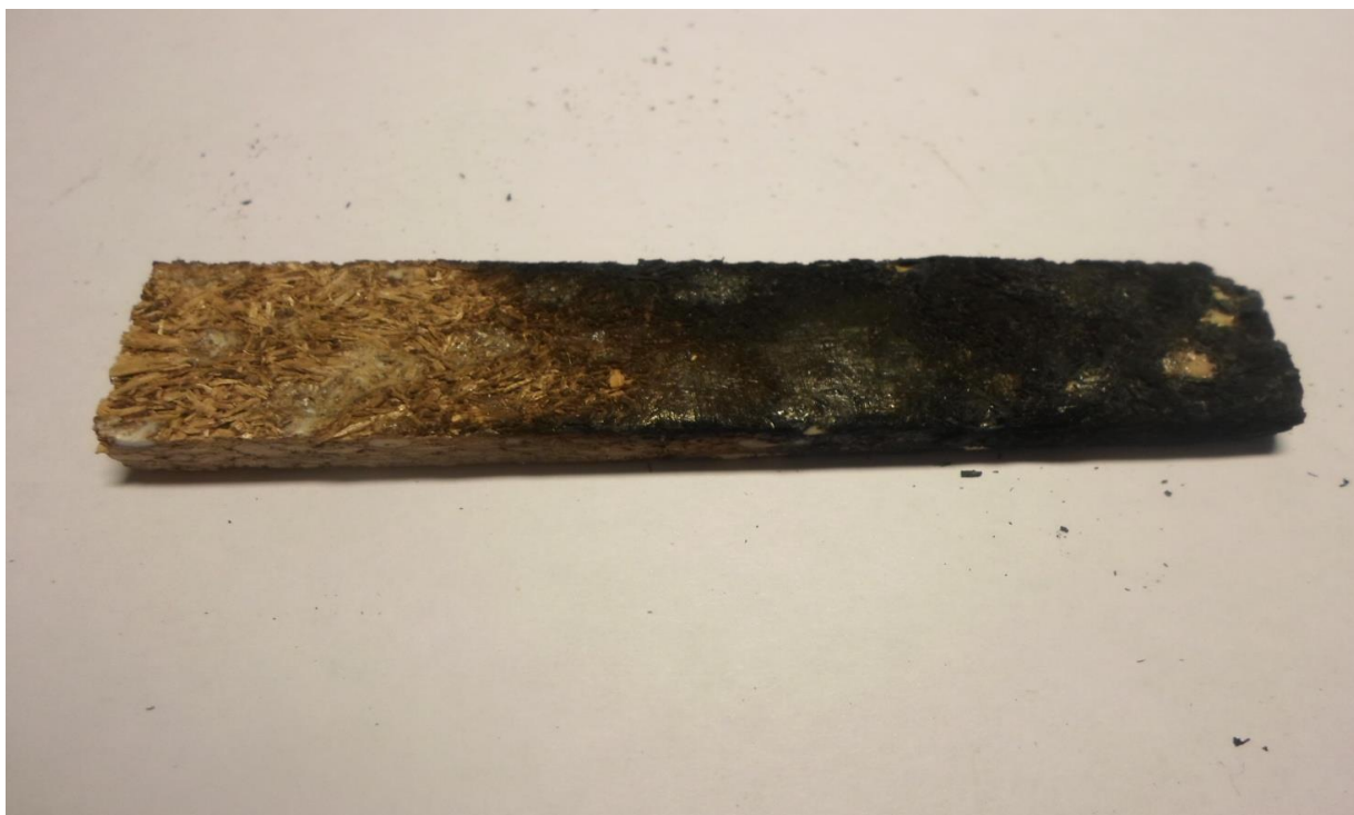
Рис. 2. Образец композита с добавкой фтористого натрия после испытания в огневой трубе
